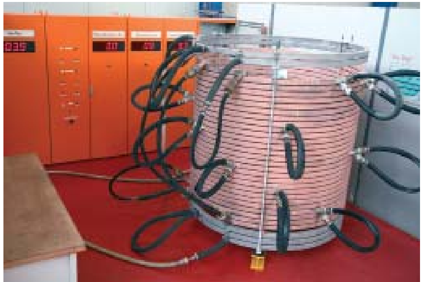
Bild 3: Ofenspule im Prüffeld.
